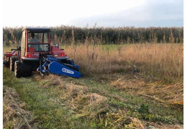
Das Heckmäherwerk eignet sich besonders gut für die Mahd an schlecht erreichbaren Stellen wie Gräben.
