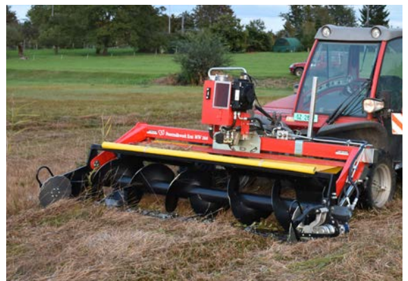
Die Schnecke vorne im Frontmäherwerk befördert das Schnittgut mittig unter das Fahrzeug und Insekten bleiben weitgehend verschont.
