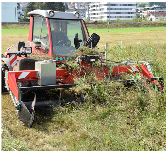
Der Testlauf im Frauenwinkel lief erfolgreich ab. Die meisten Insekten haben die Mahd überstanden. Wichtig ist, dass das Mähwerk auf eine Höhe von 10 cm eingestellt ist.
