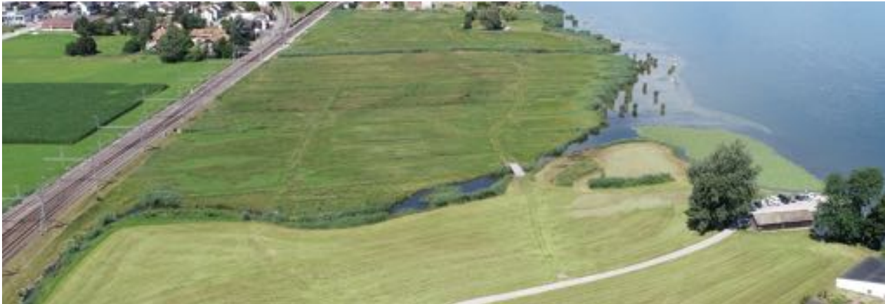
Blick auf das Pfäffiker Ried im Juli 2020: Im Vordergrund der revitalisierte Riethofbach und im Uferbereich die mit Schilf bepflanzten Flachufer-Schüttungen. Dieses Jahr wurden Erfolgskontrollen durchgeführt: Der Schilfbestand hat markant zugenommen, Makrozoobenthos und Fische weisen eine höhere Diversität auf gegenüber dem Ausgangszustand.
