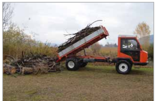
Mit bodenschonenden Kleinfahrzeugen wird das Schwemmgut zum Lagerplatz gefahren.
